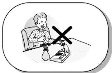
Избегайте попадания жидкости внутрь ТА. Если это произошло, немедленно отключите ТА от электрической сети и телефонной линии и поместите его в сухое место. Обратитесь в сервис-центр. В противном случае это может привести к пожару или поражению электрическим током.
