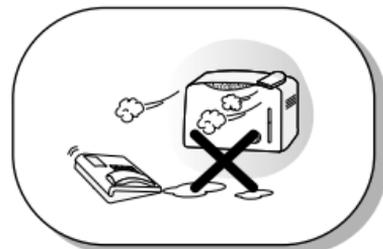
Для установки ТА выбирайте сухие помещения с хорошей вентиляцией. В противном случае это может привести к поломке ТА.
