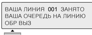
**ОБР ВЫЗ** : Если после того как Вы набрали «9» для выхода на СО линию, Вы слышите сигнал занятого, это значит, что нет свободной СО линии для совершения звонка. Для постановки в очередь на получение доступа к СО линии нажмите [ОБР ВЫЗ].
