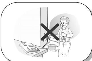
Не прикасайтесь к вилке и электрическому шнтуру мокрыми руками! В противном случае это может привести к пожару или поражению электрическим током.
