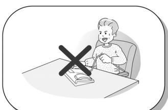
При отключении энергопотребления или телефонного шнура беритесь за вилку и аккуратно тяните её. Нельзя браться за и тянуть за электрический и телефонный шнуры! Это может привести к поражению электрическим током или поломке аппарата.
