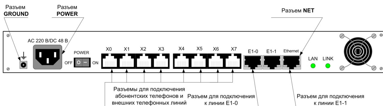
Рис. 24 – Разъемы на задней панели IP-АТС АГАТ UX-3212
