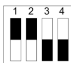
Рис. 21 – Положение переключателей при первом подключении к IP-сети
